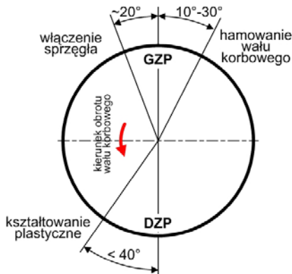
Rys. 3. Charakterystyczne okresy w działaniu prasy mimośrodowej
